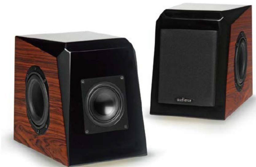
●形式：フルレンジ ●ユニット：7.6cmフルレンジ×2、バッジエクイーター×2 ●推奨アンプ出力：50W以下 ●インピーダンス：8Ω ●再生周波数：22Hz～43kHz ●出力音圧レベル：87dB ●外形寸法：150W×200H×250Dmm ●重量：3.2kg
